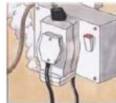
Curto-circuitos por sobrecarga de utilização
