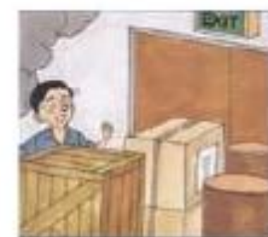
Saídas de emergência obstruídas (podem agravar consequências do incêndio)
